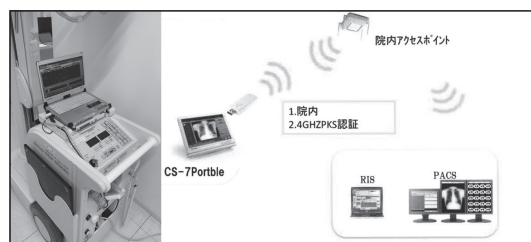
図2. ポータブル装置と無線概略図
